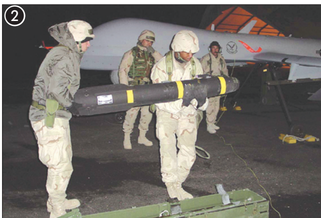
БЛА «Предатор»: подготовка к полету для уничтожения цели (1. Проверка бортовых систем БЛА MQ-1 «Предатор-А» американскими военно-служащими в Ираке. 2. Подвеска ПТУР AGM-114С «Хелл-файр» на БЛА. 3. Пуск ПТУР во время испытаний. 4. Общий вид ПТУР AGM-114С. 5. Момент попадания ракеты в цель и подрыв боевой части в ходе испытаний на полигоне)
