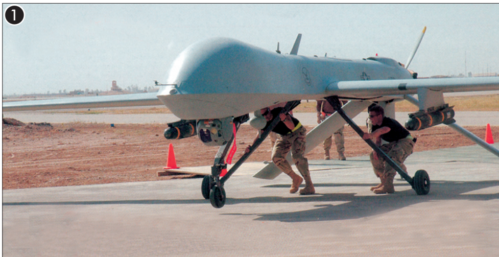
БЛА «Предатор»: подготовка к полету для уничтожения цели (1. Проверка бортовых систем БЛА MQ-1 «Предатор-А» американскими военно-служащими в Ираке. 2. Подвеска ПТУР AGM-114С «Хелл-файр» на БЛА. 3. Пуск ПТУР во время испытаний. 4. Общий вид ПТУР AGM-114С. 5. Момент попадания ракеты в цель и подрыв боевой части в ходе испытаний на полигоне)
